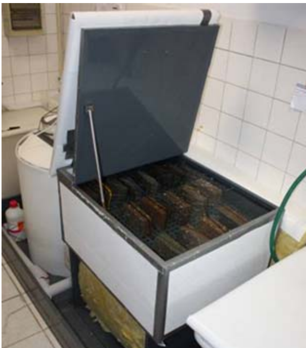
Abbildung 2: Thermisch isolierter Säureprüfstand mit pH-Wert-Sensor, inkl. Säuretitration und eingebautem Thermoelement, Labor MFPA Leipzig GmbH
