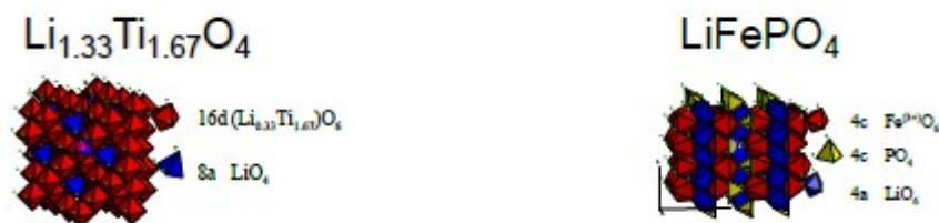
Figur 1: Kristallstrukturen von Lithiumtitanat und Lithiumeisenphosphat [1] . Guerfi et al. [2] zeigen, dass dieses Batteriesystem über 20.000 Zyklen ohne nennenswerten Kapazitätsverlust betrieben werden kann (siehe Figur 1).
